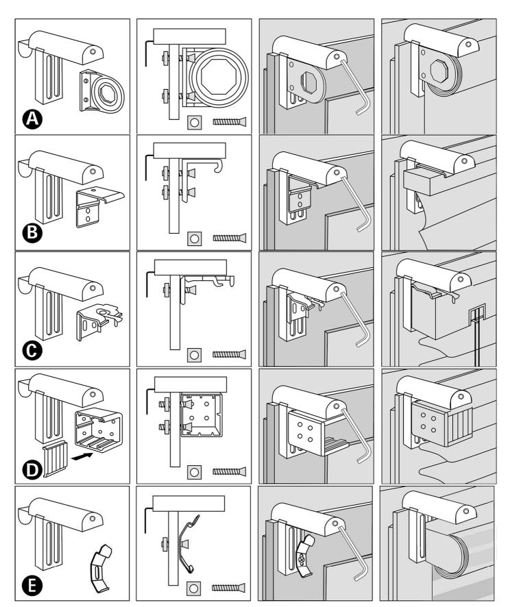
Schritt 1: Setzen Sie die Halterung auf den Klemmflex® Klemmträger.
