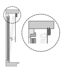
Lichte Breite der Laibung messen (oben), abzüglich ca. 5cm ergibt das Rollo-Stoffmaß. Lichte Höhe der Laibung zzgl. ca. 10 cm ergibt die Rollohöhe. Achten Sie darauf, dass das Rollo nicht die Fenster beim Öffnen behindert.
