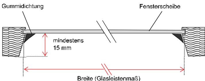
Messen Sie, wie die oberen Abbildungen zeigen, an drei Punkten der Innenkante der Glasleiste die Breite der Fensterscheibe aus.
