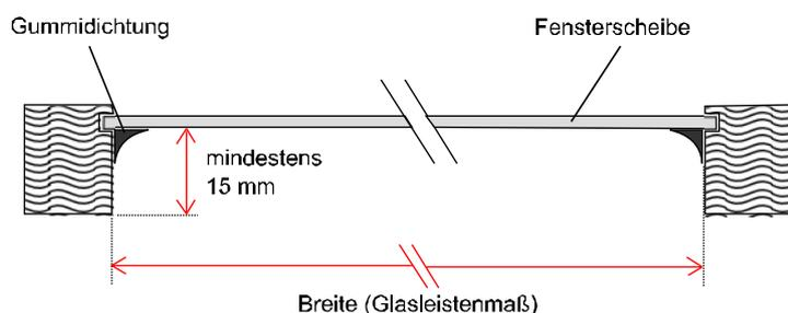
Messen Sie, wie die oberen Abbildungen zeigen, an drei Punkten der Innenkante der Glasleiste die Breite.
