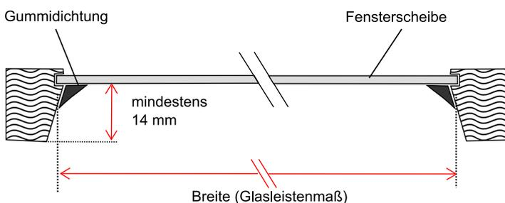
Messen Sie, wie die oberen Abbildungen zeigen, an drei Punkten der Innenseite der Glasleiste die Breite der Fensterscheibe aus.
