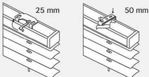
4. Schließen Sie den Riegel der Träger.
