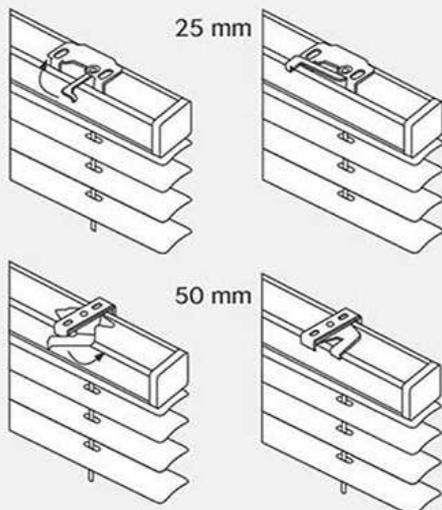
5. Setzen Sie die Blende auf die Oberschiene.
