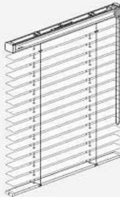
I50 EnV - Ausführung mit Endlosschnur - Getriebe **vorn** auf der Oberschiene
