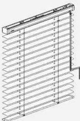
I50 Ku - Ausführung mit Kurbel, Getriebeabgang 45°
