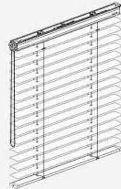
I50 EnS - Ausführung mit Endlosschnur - Getriebe **seitlich** an der Oberschiene
