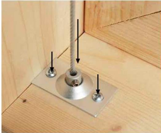
Ziehen Sie den Draht durch das Loch der Feststellschraube und fixieren Sie den Draht mit dem Imbusschlüssel.
