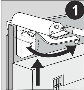
Setzen Sie den Jalousie-Klemmträger auf den Fensterflügel und schrauben Sie ihn fest. Setzen Sie die Abdeckkappe auf die Schraube und drehen Sie den Metallbügel nach rechts.
