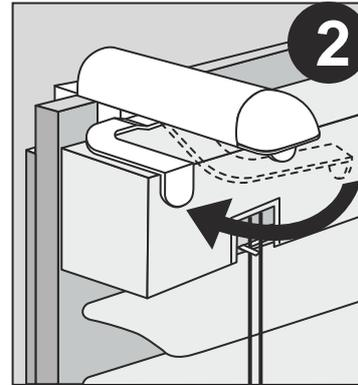
Halten Sie die Oberschiene der Jalousie direkt unter den Klemmträger und drehen Sie den Metallbügel wieder nach links.
