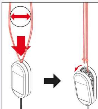
**Alle schnurbedienten Anlagen werden mit einer Sicherheitsschnurquaste ausgeliefert. Diese öffnet sich, sobald die Schnüre 60 mm auseinandergezogen und gleichzeitig mit 6 kg belastet werden.**
