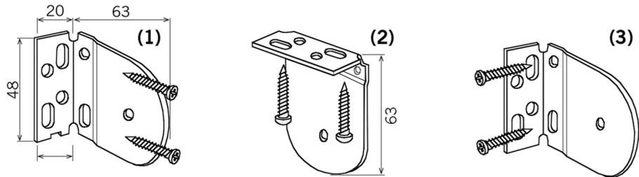
Achten Sie darauf, dass der zweite Träger genau waagrecht (4) zum ersten Träger ist, bohren Sie die Löcher und montieren Sie den Träger.
